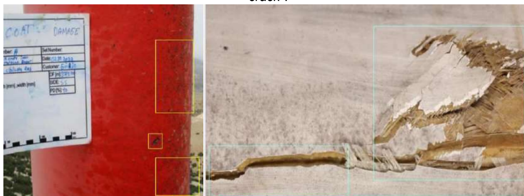
Figura 4 - Imagens provenientes dos datasets públicos com anotações das classes “ coating damage ” e “ crack ”.
