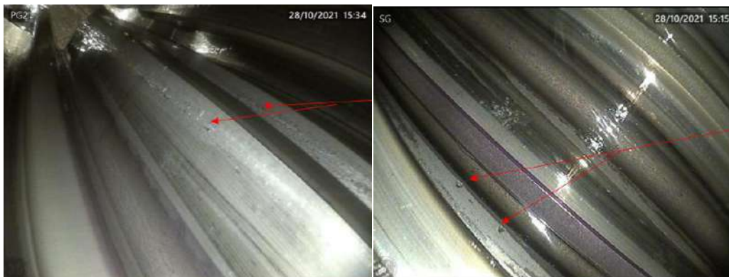
Figura 3 – Início de scuffing na face dos dentes de engrenagens planeta e sol do sistema planetário da caixa de engrenagens.
