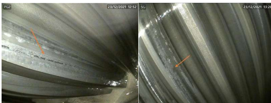
Figura 4 – Início de micropittings nos dentes de engrenagens planeta e sol do sistema planetário da caixa de engrenagens.
