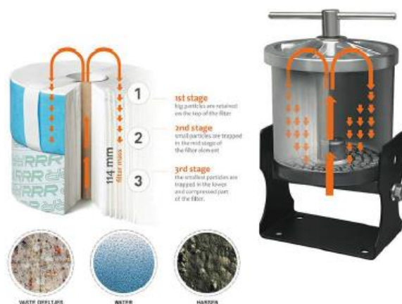
Figura 6 – Representação do funcionamento de um filtro offline.
