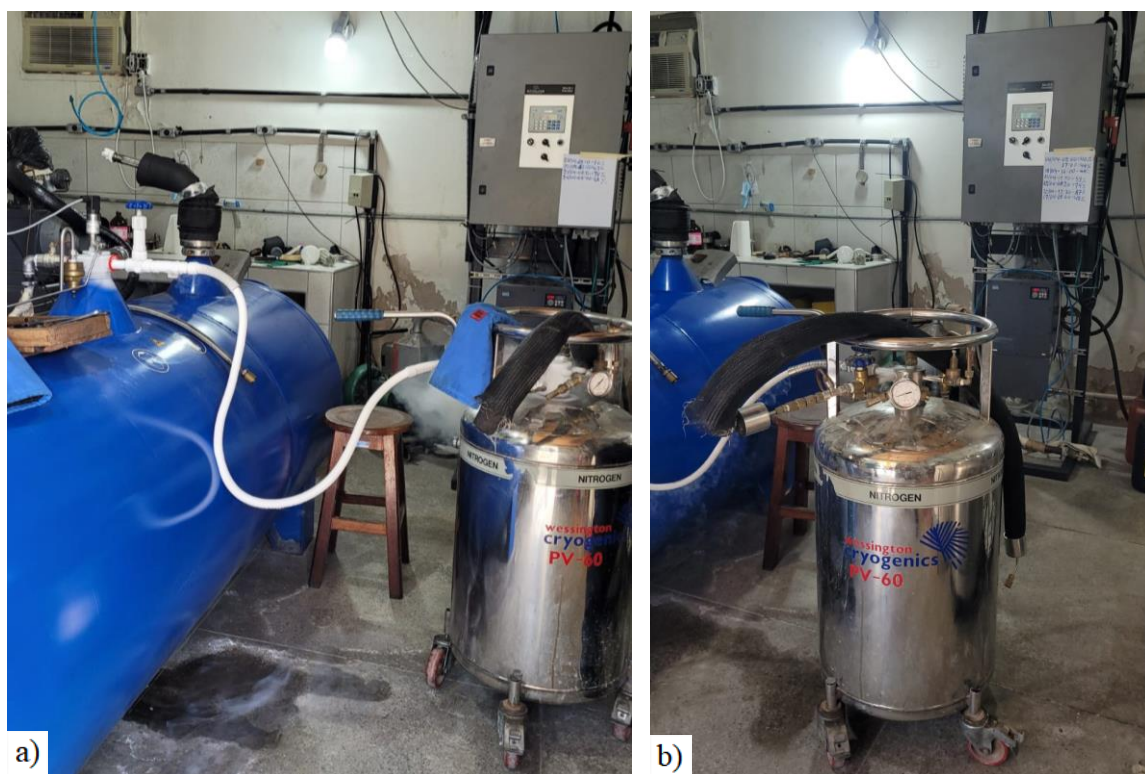
Figura 3 – a) Fornecimento de nitrogênio líquido; b) Frasco dewar para armazenamento e transporte de N_2 .
