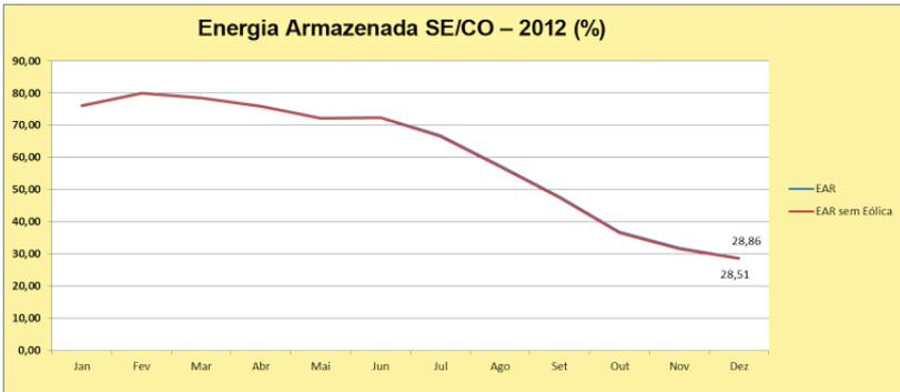
Gráfico 5 – Comparação entre EAR no SE/CO com e sem fonte eólica em 2012 (Fonte: ONS/ABEEólica)
