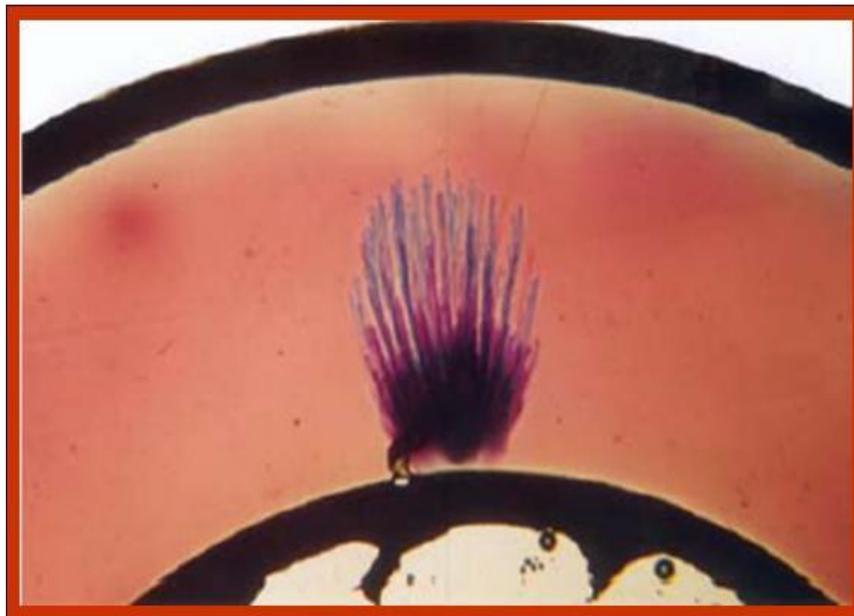
Figura II: Imagem de falha na isolação de cabo de média tensão
