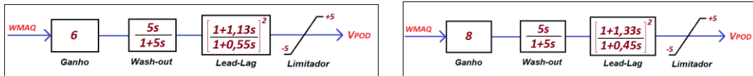
Figura 30 - Parâmetros utilizados para o controlador POD na malha de V_{dr} e V_{qr}
