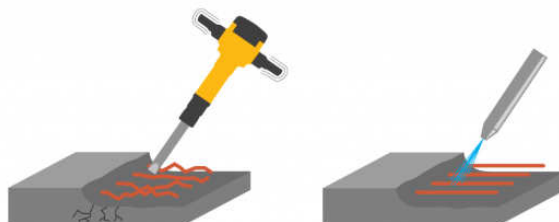
Figura 7 – Corte seletivo do concreto sem danos a ferragem (Fonte: CONJET AB, 2018 [4]).
