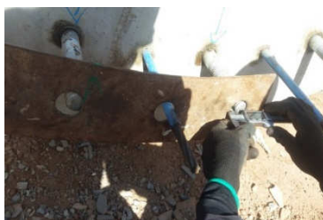
Figuras 2 e 3 – Medições dos desalinhamentos dos tirantes (Fonte: Dois A Tower System).
