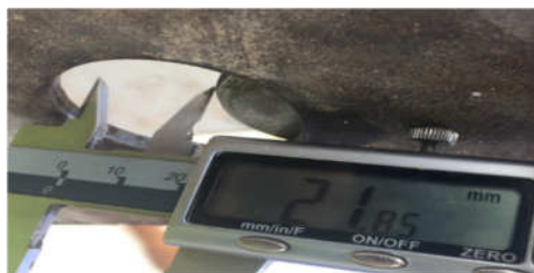
Figuras 2 e 3 – Medições dos desalinhamentos dos tirantes (Fonte: Dois A Tower System).
