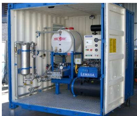
Figura 6 – Bomba de hidrojato UAP (Fonte: DTS Dois A Tower System).
